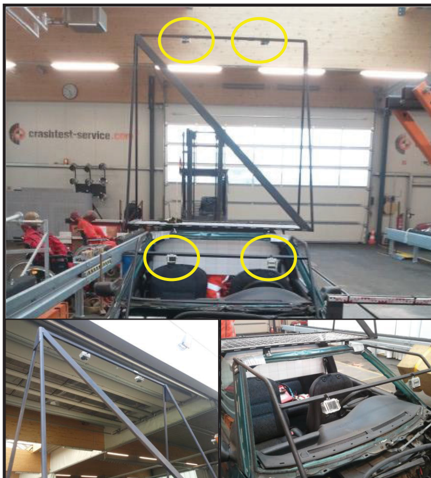
Abb. 15: Positionierung der Hochgeschwindigkeitskameras ; zwei Kameras (mit gelben Kreisen markiert und jeweils links und rechts unten am Bild vergrößert dargestellt) wurden oberhalb der Fahrzeuginsassen (Vogelansicht) und zwei vor den Fahrzeuginsassen positioniert (Frontalansicht)
