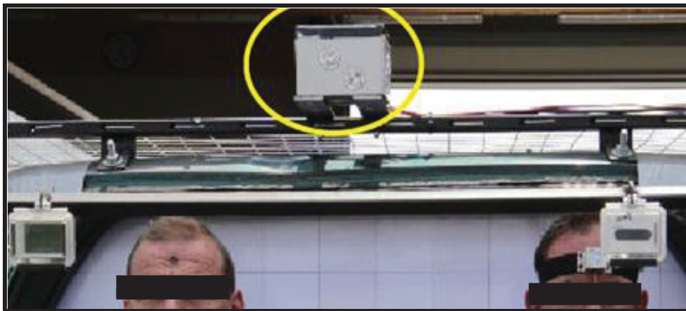
Abb. 10: Lampe ; die Lampe (mit gelbem Kreis markiert) die verbunden war mit dem Kontaktsensor. Sobald das Pendel gegen den Kontaktsensor prallte, blitzte die Lampe auf und stellte somit den Kollisionsbeginn dar
