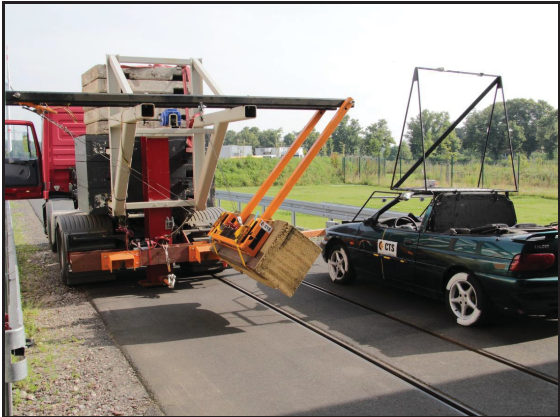
Abb. 1: Pendelkonstruktion ; Auf der linken Seite der Lkw als Zugfahrzeug vom Typ Mercedes Benz Actros mit dem ausgelegten pendelnden Gewicht, das den Pkw auf der rechten Seite vom Typ Ford Escort Cabrio auslenken soll
