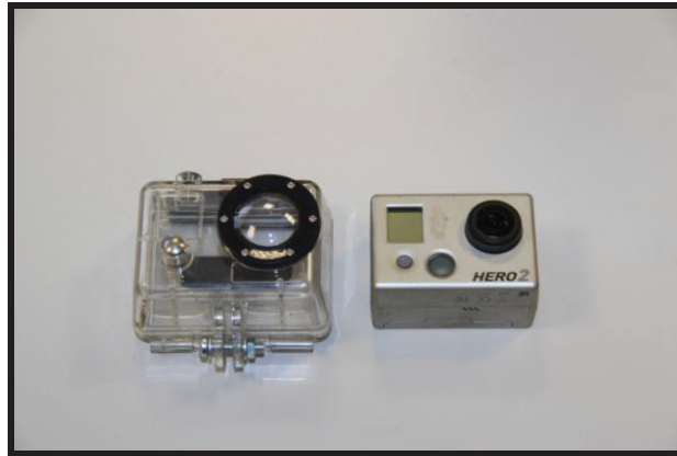
Abb. 14: Hochgeschwindigkeitskamera ; die Hochgeschwindigkeitskamera von der Firma GoPro Hero 2 mit 60fps
