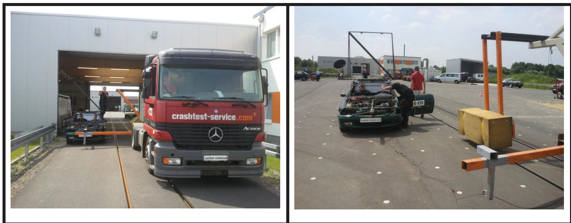
Abb. 12: Start- und Endposition der Kollision ; Links zeigt die Startposition der Kollisions-Situation, rechts zeigt die stattgefundenene Kollision und Endposition der Kollisions-Situation
