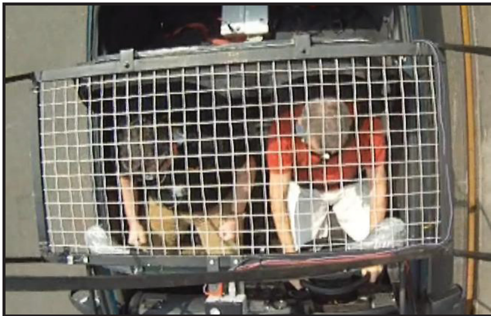
Abb. 3: Bildmaterial in Vogelperspektive ; Aufnahme der installierten Hochgeschwindigkeitskameras (Typ GoPro Hero 2, 60fps)
