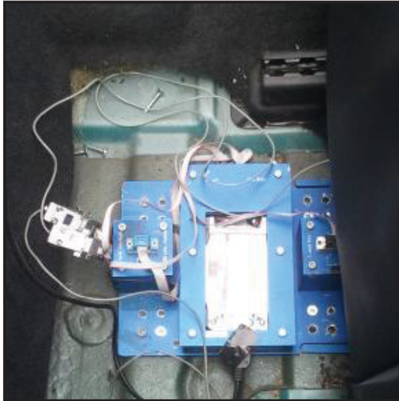
Abb. 13: Unfalldatenspeicher ; der Unfalldatenspeicher von der Firma VDO Kienzle
