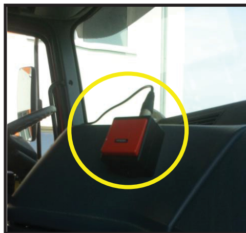
Abb. 7: Triggermechanismus ; der Triggermechanismus (mit gelbem Kreis markiert) im Fahrerhaus der das Pendel aus der Halterung löst
